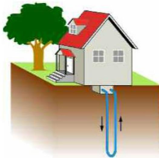
**Schema einer Erdwärmesondenanlage**
