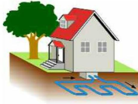
**Schema einer Erdwärmekollektorenanlage**
